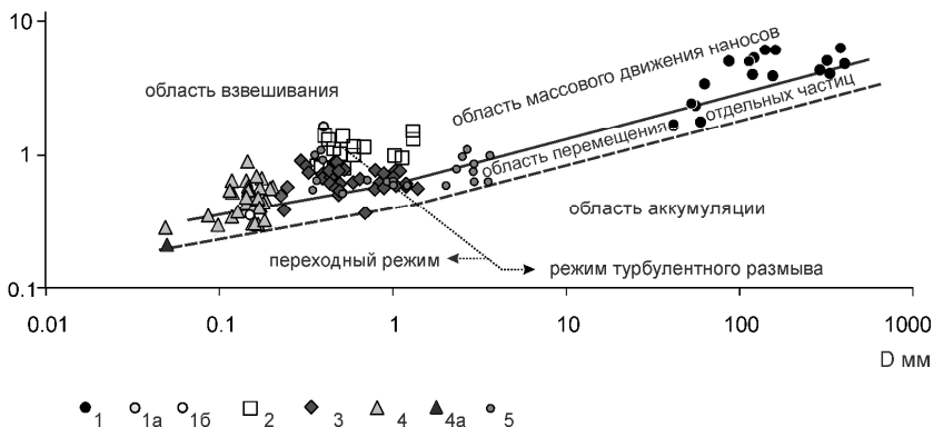
Рис. 1. Области массового влечения наносов, остановки перемещения по дну, перемещения во взвеси или аккумуляции и границы между ними, рассчитанные по формулам (18) и (19) по данным измерений: на р. Терек (1) в верхнем и среднем течении, (1a) ниже устья р. Сунжи, (1б) на выходе в море; (2) на р. Вычегде на Нижне-Шешуровском перекате; (3) на р. Нигер ниже впадения р. Бенуэ; на р. Яне (4) в низовьях и (4a) на устьевом баре; (5) на р. Чулым в районе с. Белый Яр.
