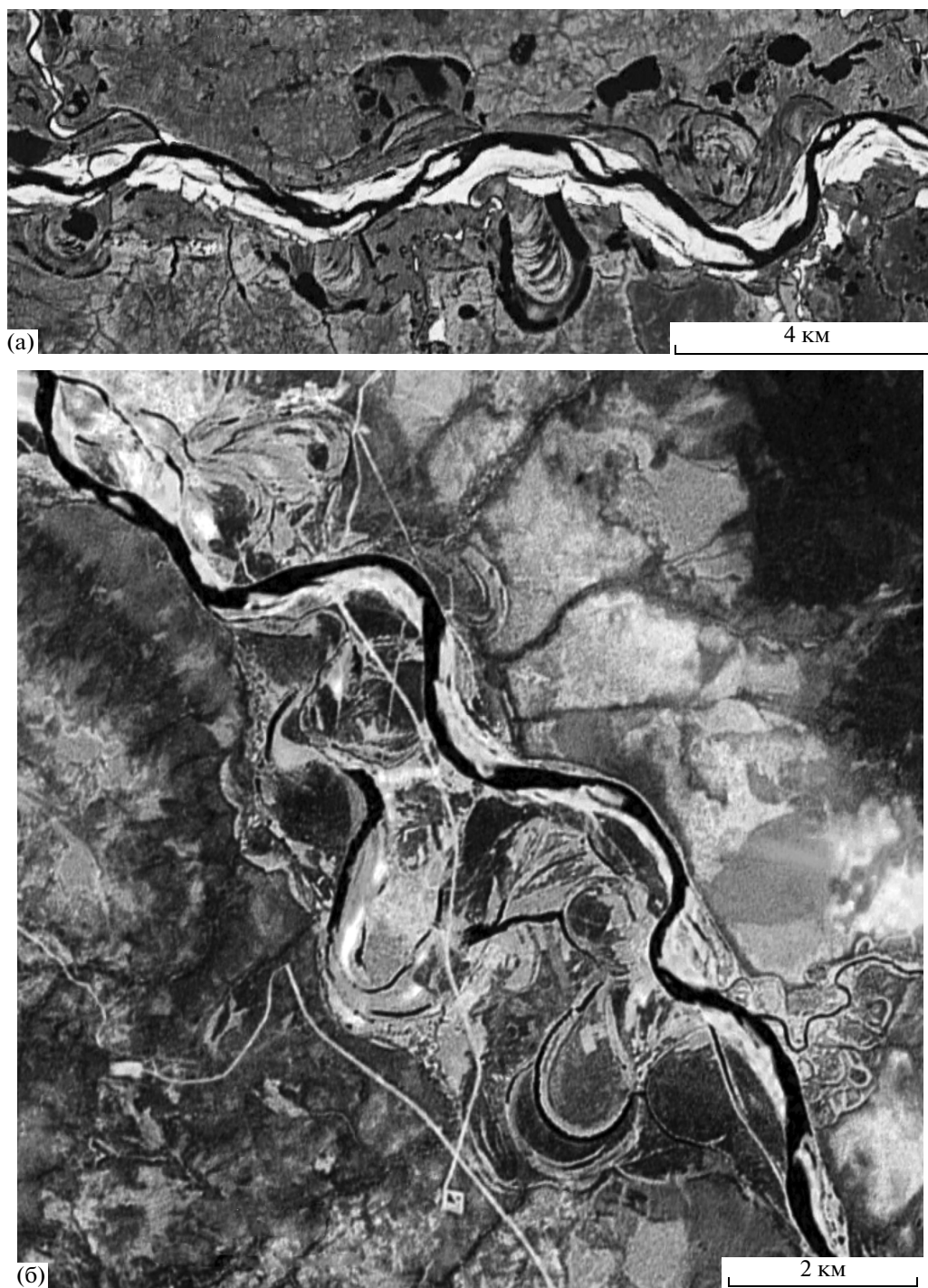
Рис. 2. Трансформация русла из крутомеандрирующего с малыми излучинами в пологомеандрирующее с большими излучинами и побочными на реках Хадуттэ (приток нижнего Пура, № 19 в табл. 1) – участок с двухсторонней поймой (а) и Мезени (№ 6 в табл. 1) – участок с односторонней поймой (б).
